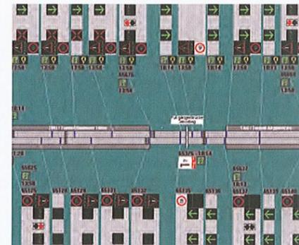
Berlin-Brandenburg im Brandenburgischen Autobahnamt Stolpe eingerichtet. Die Unterzentrale arbeitet weitgehend im Automatik-Betrieb. Hierzu gehören Schaltungen bei Stau, dichtem Verkehr oder bei Ereignissen im Tunnel. Zum Beispiel wird beim Öffnen einer Notruf-Tür die zulässige Höchstgeschwindigkeit sofort auf 60 km/h reduziert und bei Brand der Tunnel sofort gesperrt.
